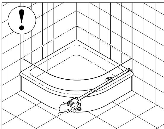
PL UWAGA! Powierzchnia montażowa powinna być czysta, równa, stabilna bez widocznych spękań.
