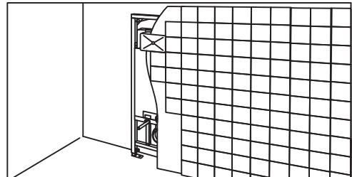
1. Установите, закрепите, отрегулируйте инсталляционную систему согласно инструкции по монтажу (поставляется в комплекте с инсталляцией). Надежно соедините отвод инсталляционной системы с канализацией и подведите систему водоснабжения.
