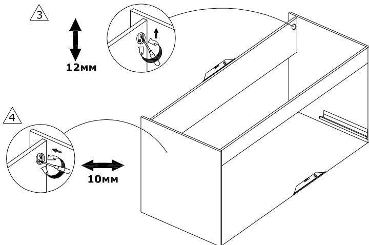
**4. После регулировки туго затяните крепления, используя нижние винты навесов.**
