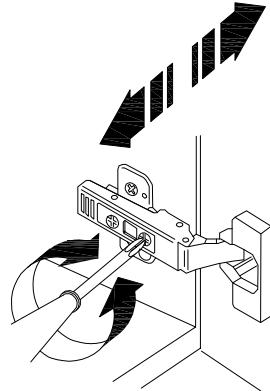
**Регулировка по глубине**
