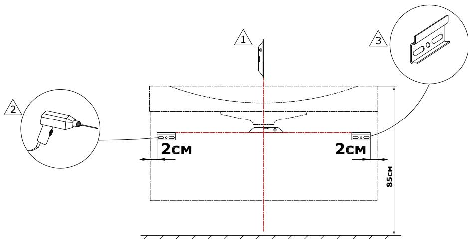
**1. Произведите разметку стены и закрепите монтажные планки.**
