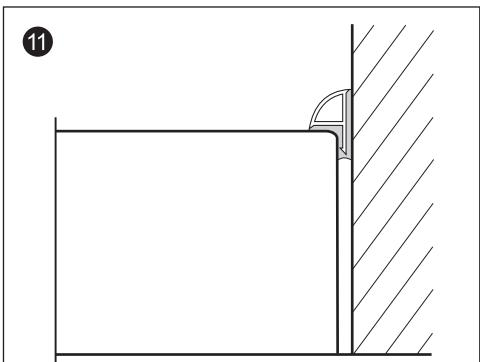
Помимо герметизации поддона санитарным силиконом, мы рекомендуем использовать отделочные пластиковые уголки между поддоном и стеной ванной комнаты, наложенные на санитарный силикон.
