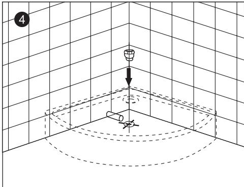
Соедините водопроводную систему и нижнюю часть сливного сифона (с полностью соединёнными трубами) с поддоном.
