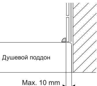
**Внимание:** мы рекомендуем осуществлять сборку поддона в углу ванной комнаты, чтобы в том числе, закрепить поддон к стенам облицованым керамической плиткой. В случае установки поддона "под плитку", она должна закрыть стену с запасом, таким образом, чтобы плитка накладывалась на край поддона, при толщине наложения не более 10 мм.
