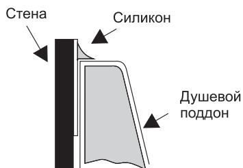
Соединяемые поверхности должны быть чистыми и сухими. Заполните места соединения поддона и стены санитарным силиконом. После завершения сборки снимите защитную пленку с остальной части поддона.
