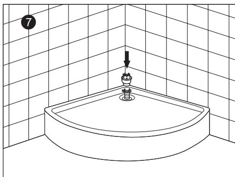
Снимите защитную плёнку с краёв поддона, соприкасающихся с полом и стенами, затем установите верхнюю часть сливного сифона.
