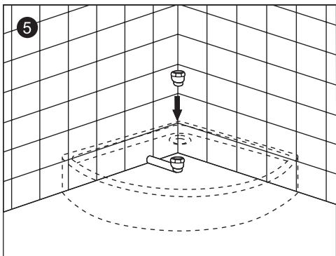
Соберите сливную трубу и нижнюю часть сифона и соедините их с канализационной системой так, чтобы сифон совпадал со сливным отверстием в поддоне.
