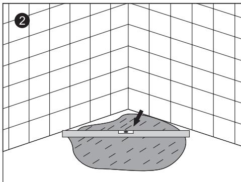
Место предполагаемой сборки поддона необходимо выровнять. Это можно сделать при помощи бетонной стяжки, используя уровень.
