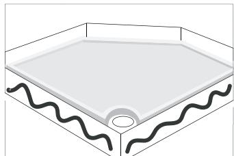
Установите ножку (Шаг 1), чтобы ножка не выступала за край душевого поддона после его установки, а затем зафиксируйте душевой поддон с помощью санитарного силикона, приложив к поверхности стороны, прилегающей к стене (Шаг 2).
