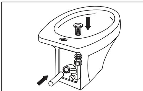
2. Вкрутите сливную решетку (горловину), сифон и отводную гофрированную трубу в технологические отверстия биде согласно инструкции по монтажу (поставляется в комплекте со сливной арматурой).
