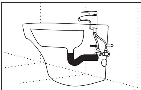
5. Подключите изделие к канализации и системе холодного/горячего водоснабжения.
