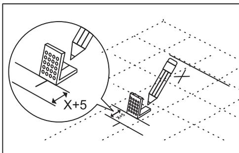
3. Поставьте биде на заранее выбранное для него место на пол. Обведите биде по контуру и отметьте положения установочных отверстий. После этого, уберите биде и по отмеченному контуру расположите крепежные уголки на расстоянии ( $x+5$  мм) от контура, где  $x$  – толщина керамики.
