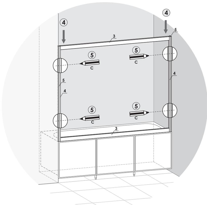
6. Просверлите стены и установочный профиль (рис.6).
