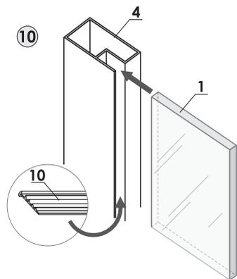
10. Неподвижные стекла (без отверстий) вставьте в пазы вертикальных рамочных профилей и зафиксируйте уплотнителем (рис.10).
