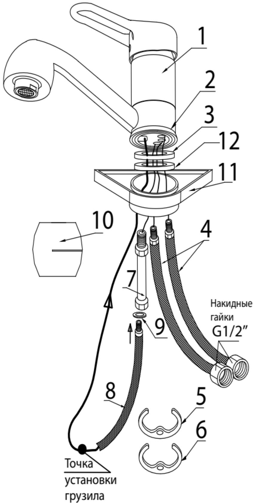
скобу 5 и металлическую скобу 6 и закрепите конструкцию гайкой на шпильке 7. Прикрутите вытягивающийся шланг 8 к шпильке 7 через прокладку 9.
