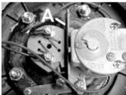
Rysunek 17 – Separator plastikowy / A: separator plastikowy
