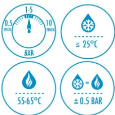
Det anbefales ikke å bruke termostatbatteri med gjennomløps varmvannberedere.
