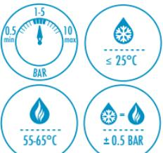
Nem ajánljuk a termosztátos csaptelepet gáz vagy elektromos átfolyós vízmelegítővel használni.
