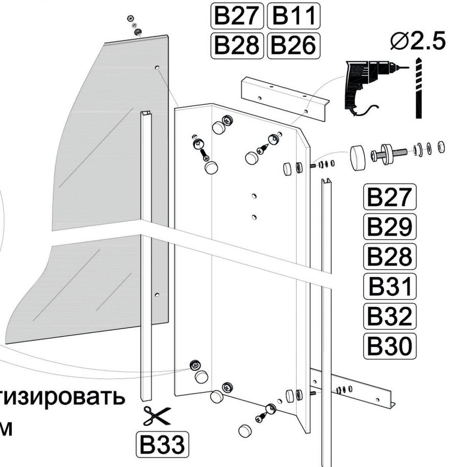
Место примыкания герметизировать нейтральным силиконовым герметиком
